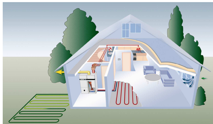
Η Αντλία Θερμότητας Εδάφους / Νερού της Dimplex αντλεί ενέργεια από το υπέδαφος (χώμα, νερό) προσφέροντας τη δυνατότητα θέρμανσης και ψύξης εσωτερικών χώρων με εξοικονόμηση ενέργειας από 55-65%.
