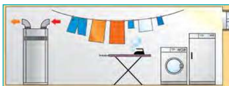
DHW και αφύγρανση χώρου
